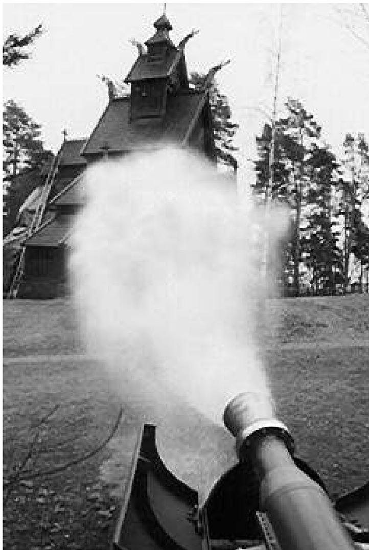
Prueba de un cañón de agua (extintor contra incendio de agua pulverizada)
