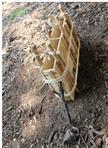
Reproducción del sistema constructivo de una tapia de piedra poma y cal en laboratorio con el molde original de madera. Facultad de Arquitectura de la UNAM. LABPYSCT. Septiembre de 2015. Fabricación del molde: Aida Jiménez López. Fotografía: Carolina Sandoval Marmolejo.
