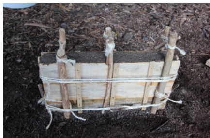
Reproducción del sistema constructivo de una tapia de piedra poma y cal en laboratorio con el molde original de madera. Facultad de Arquitectura de la UNAM. LABPYSCT. Septiembre de 2015. Fabricación del molde: Aida Jiménez López. Fotografía: Carolina Sandoval Marmolejo.
