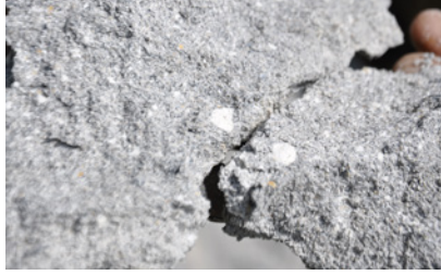
▲ Residuos del proceso de calcinación de la roca caliza, conocido en la localidad como excedente de cal o granzón. Los puntos blancos que se observan son las partículas de óxido e hidróxido de calcio, y el resto es arena inerte. Tepeyahualco, Puebla. LABPysCT. Septiembre de 2015. Crédito: Ángeles Vizcarra de los Reyes.
