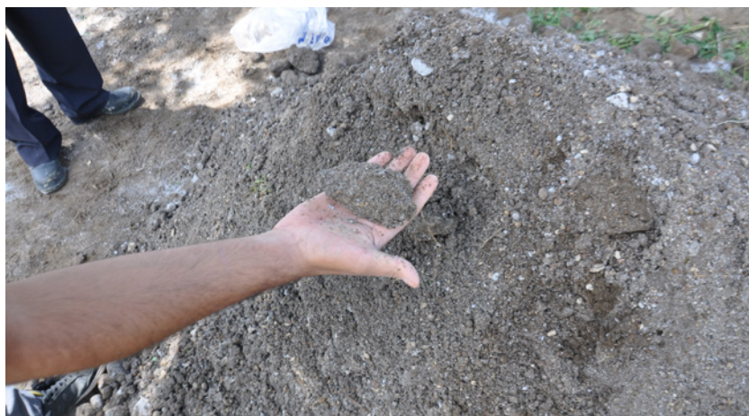
▲ Prueba para identificar la cantidad exacta de agua de la mezcla. Tepeyahualco, Puebla. LABPYSCT. Septiembre de 2015. Crédito: Ángeles Vizcarra de los Reyes.
