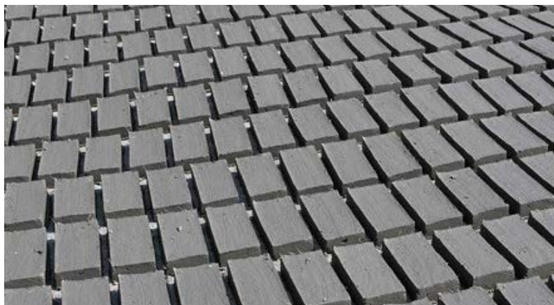
Imagen 33. Fabricación de tabiques de cemento-arena. Imagen Creative Commons.
