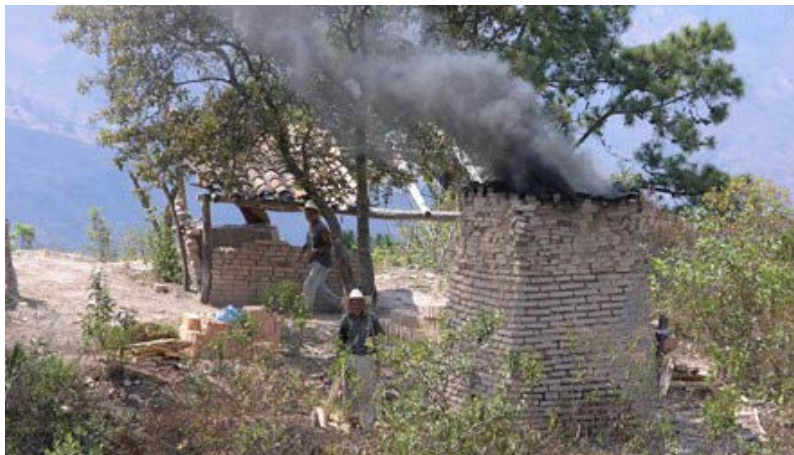
Imagen 32. Horno para fabricar tabiques, tejas y ladrillos. Honduras. Imagen Creative Commons.
