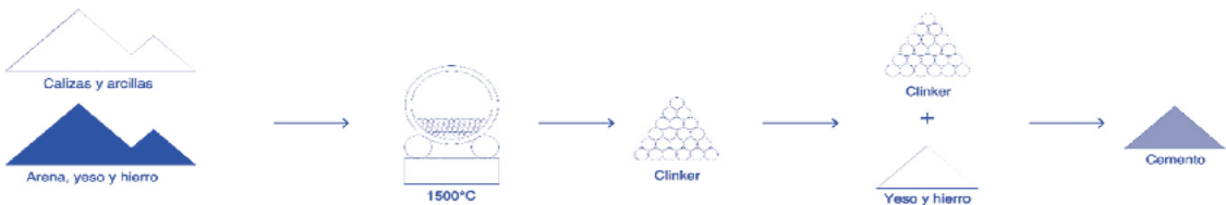
Figura 9. Proceso de producción del cemento. Elaboración: Ana Cedillo, basado en Desplazes.
