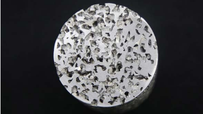
Imagen 47. Espuma metálica. Fuente: Academia Mexicana de Ciencias.
