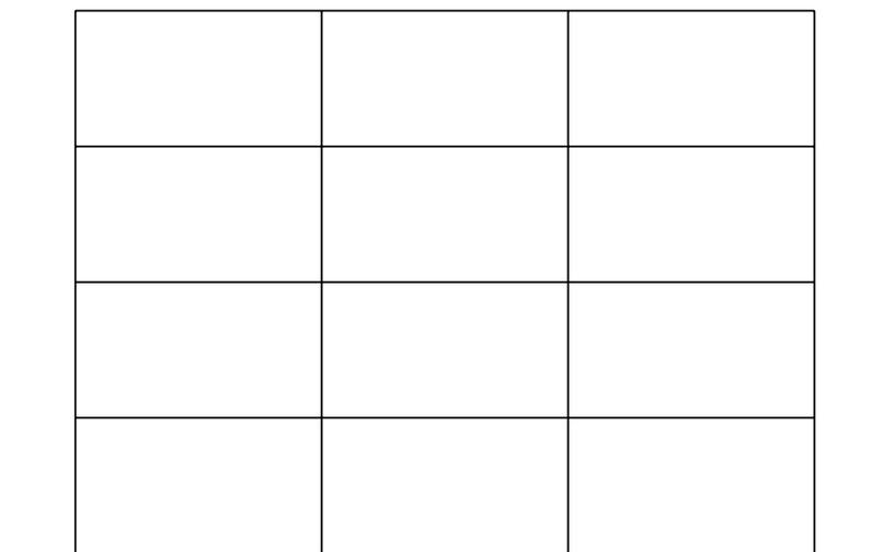
**Figura 8** Pórtico no arriostrado (aunque puede considerarse sin flecha horizontal si es suficientemente rígido, o sea, si resiste cargas horizontales sin sufrir deformaciones)
